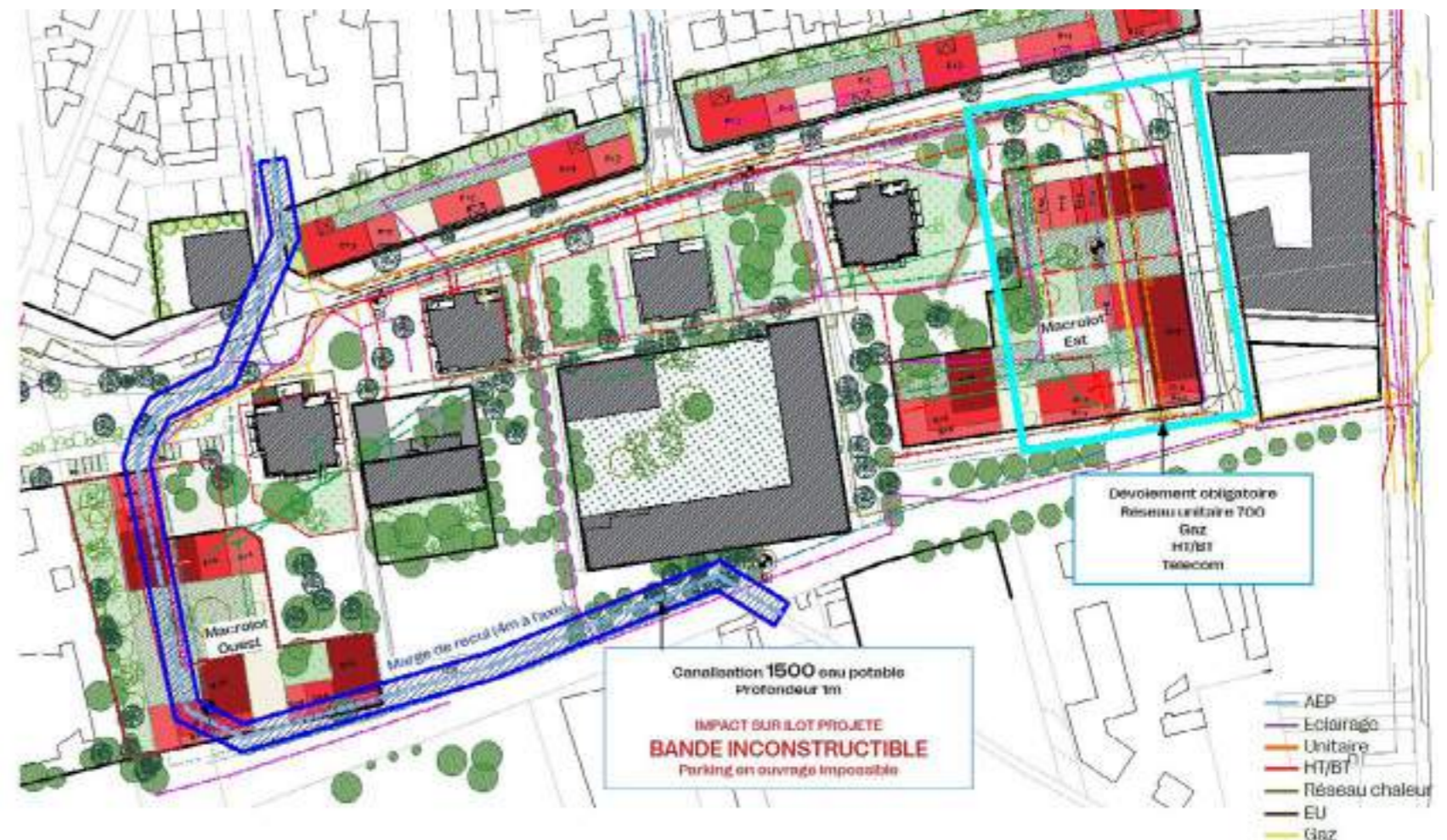
Plan de recollement des réseaux invalidant un scénario de faisabilité (source Atelier Marniquet Aubouin, 2023)
