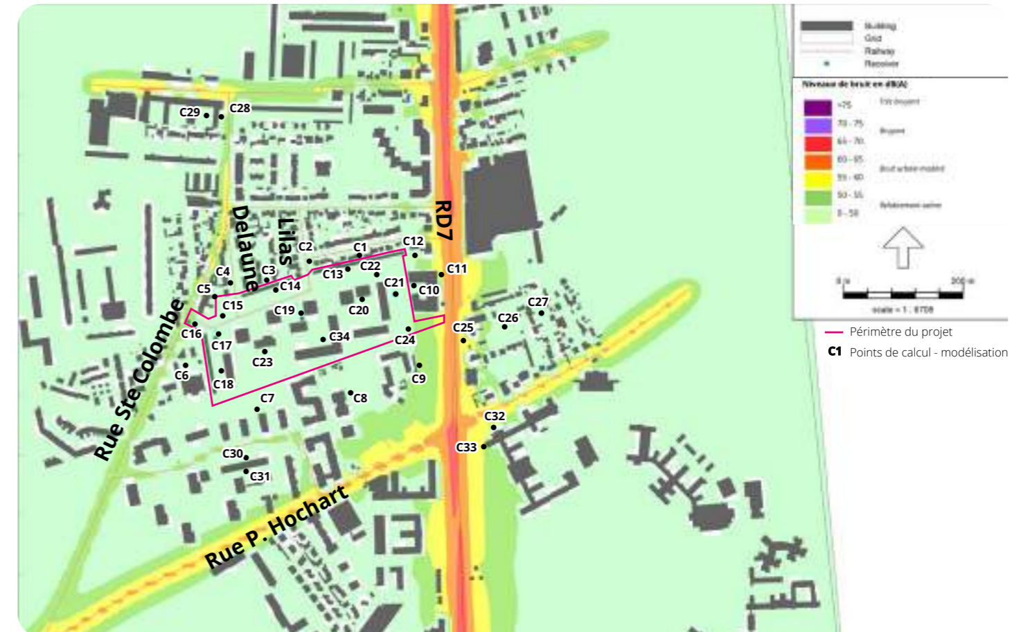
Carte des niveaux sonores calculés à 4 m - Ln indicateur du niveau de bruit nocturne (source TRANS-FAIRE, 2020)
