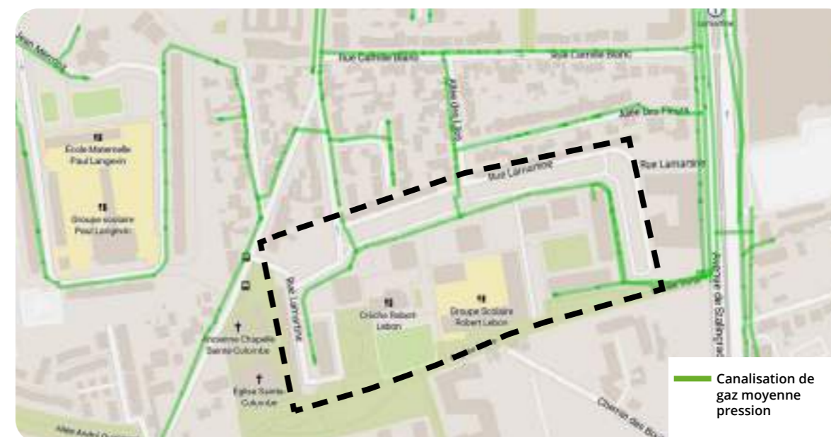
Réseau de gaz GRDF (source GRDF, 2023)
