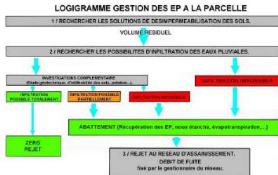
Schéma de la gestion des EP à la parcelle selon le Règlement de Service Territorial de l'assainissement EPT GOSB (source EPT GOSB, 2019)
